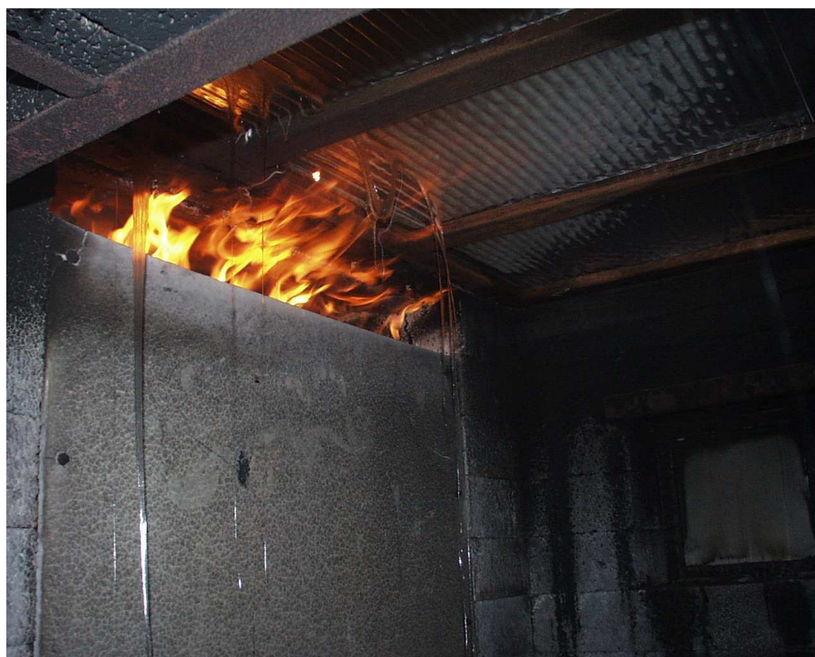
Detail zkušebního vzorku č. 1 při zkoušce (2. min zkoušky)
